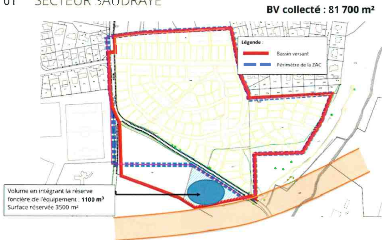
Figure 11 : Bassin versant, périmètre de la ZAC « Saudraye » et localisation de l'ouvrage de rétention (source : Gwenaël Desnos, 2014)
