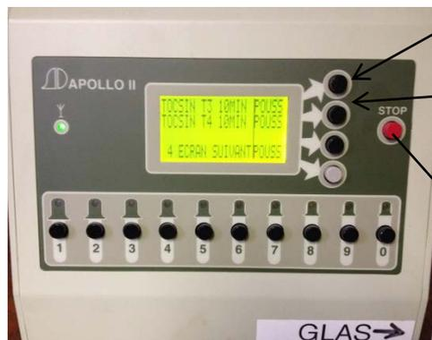
Au cas où l'alerte du Tocsin n°3 ne se déclencherait pas, appuyer sur le bouton situé en dessous, ce qui déclencherait le Tocsin de la cloche n°4.
